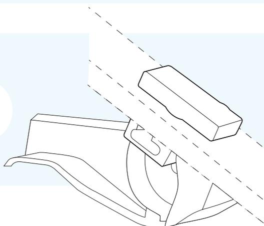
Grâce au profilage spécial dans la paroi, la butée à présent installée (toujours utiliser un set par module) permet de tirer le module au maximum vers l'extérieur et de le suspendre à un angle de 27°. Un avantage supplémentaire de l'utilisation des butées est qu'elles empêchent le module d'être retiré de l'armoire ou du rayonnage par inadvertance.
