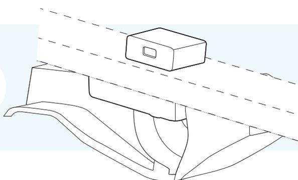
Grâce au profilage spécial dans la paroi, la butée à présent installée (*toujours utiliser un set par module*) permet de tirer le module au maximum vers l'extérieur et l'empêche d'être entièrement retiré de l'armoire ou du rayonnage par inadvertance.
