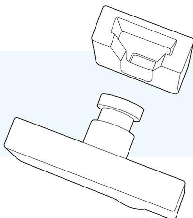
La butée se compose de deux parties. La partie longue qui peut être insérée dans les trous du module prévus à cet effet et la partie courte qui peut être glissée pour fixer la partie protubérante de l'autre élément.
