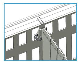
Insérez la pince en U d'un côté de la séparation sur le panier.
