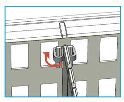
Depuis l'intérieur du panier, défaites la pince en plaçant un doigt derrière l'un des crochets et en tirant vers l'extérieur. La séparation peut à présent être retirée du module.
